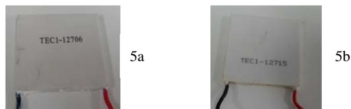
Figura 5. 5a) Célula Peltier TEC1-12706. 5b). Célula Peltier TEC1-12715
