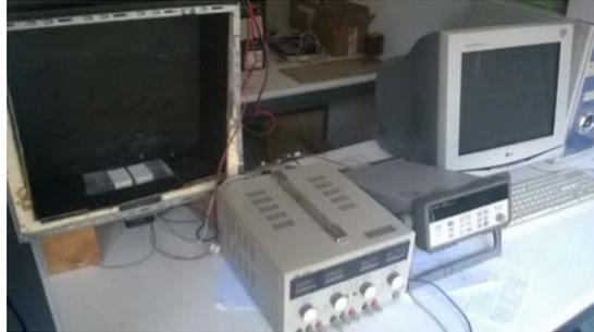
Figura 3. Esquema de los equipos y cadena de medida, caja con los disipadores, fuente de alimentación, dispositivo de recogida de datos y ordenador.
