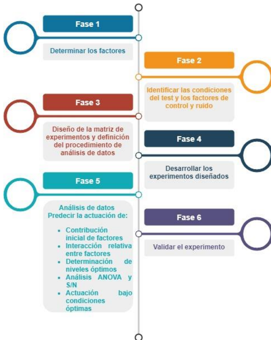
Figura 3-4. Pasos para el diseño de experimentos empleando el método de Taguchi
