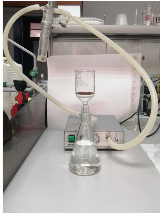
Fotografía 3-6 Montaje experimental para la filtración de la biomasa modificada
