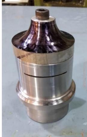
*Figura 43. Toroide mecanizado.*
