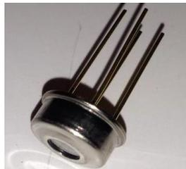
*Figura 1. Sensor infrarrojo de temperatura. MLX90614 de Melexis*
