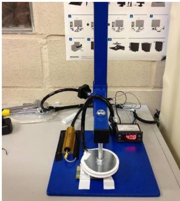
Figura 2. – Instrumento medida de cono de temperatura.
