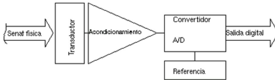
**Figura 5.3 – Diagrama de bloques de un sistema de adquisición de datos**
