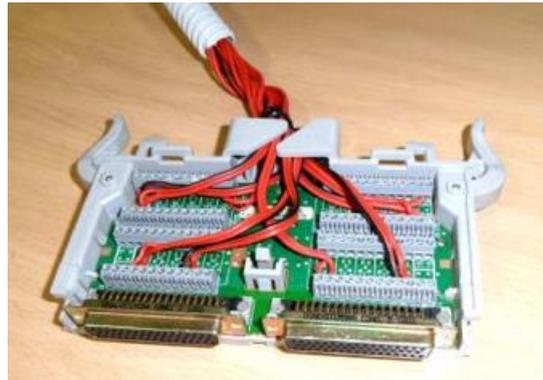
**Figura 5.3.1 a) Tarjeta multiplexora 34921A**
