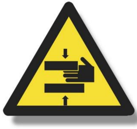
Figura 13: señal riesgo de atrapamiento entre objetos
