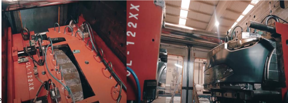
Figura 4-25. Maquinaria empleada para el moldeo de un parachoques de PPGF.
