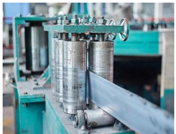
Figura 4-16. Proceso de deformación plástica (laminado).
