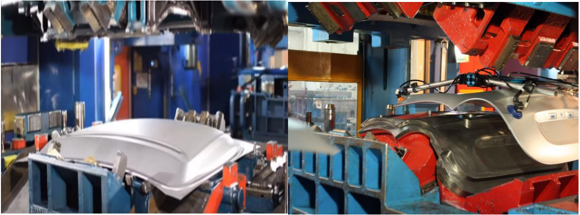
Figura 4-15. Proceso de deformación plástica (estampación en frío).
