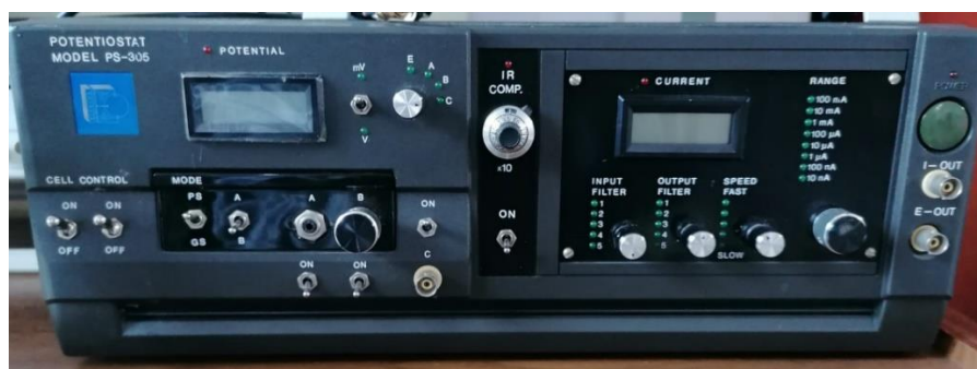
Figura 3-4: Panel frontal del potenciostato modelo PS-305.
