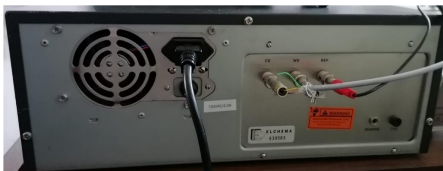
Figura 3-5: Panel posterior del potenciostato modelo PS-305.
