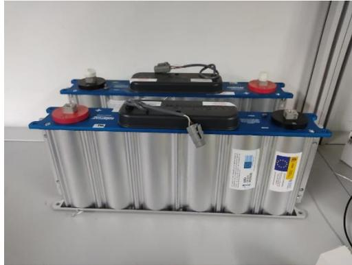
Figura 11. Supercondensador
