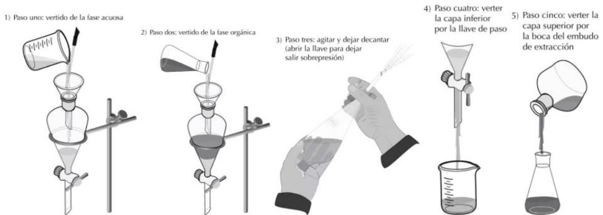
Figura 18. Esquema general de las etapas de la extracción líquido-líquido.
