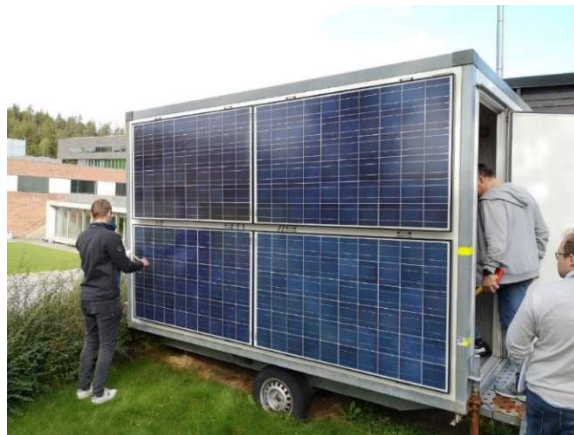
Figura 2.1 Tráiler con paneles solares y el equipo en su interior
