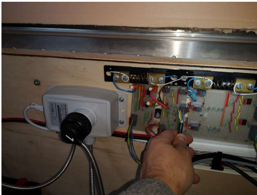
Figura 6 Desconectando el sistema electrónico con un destornillador
