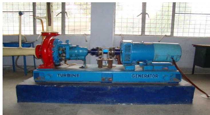
Figura 2.12. Turbina centrífuga y generador Nautiyal [13]
