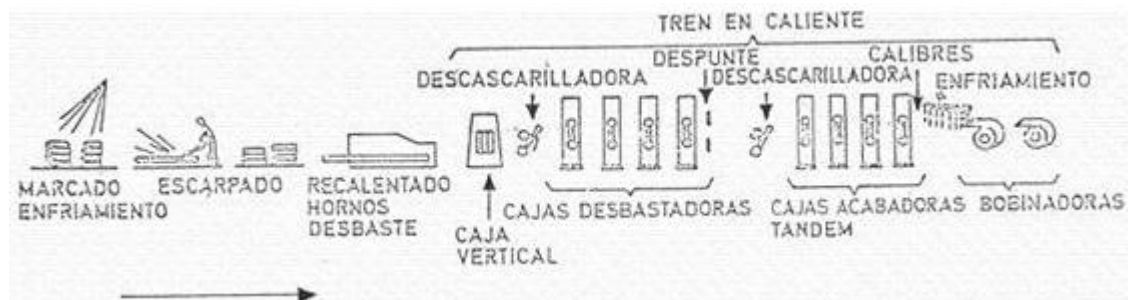
Figura 6. Proceso de laminado en caliente
