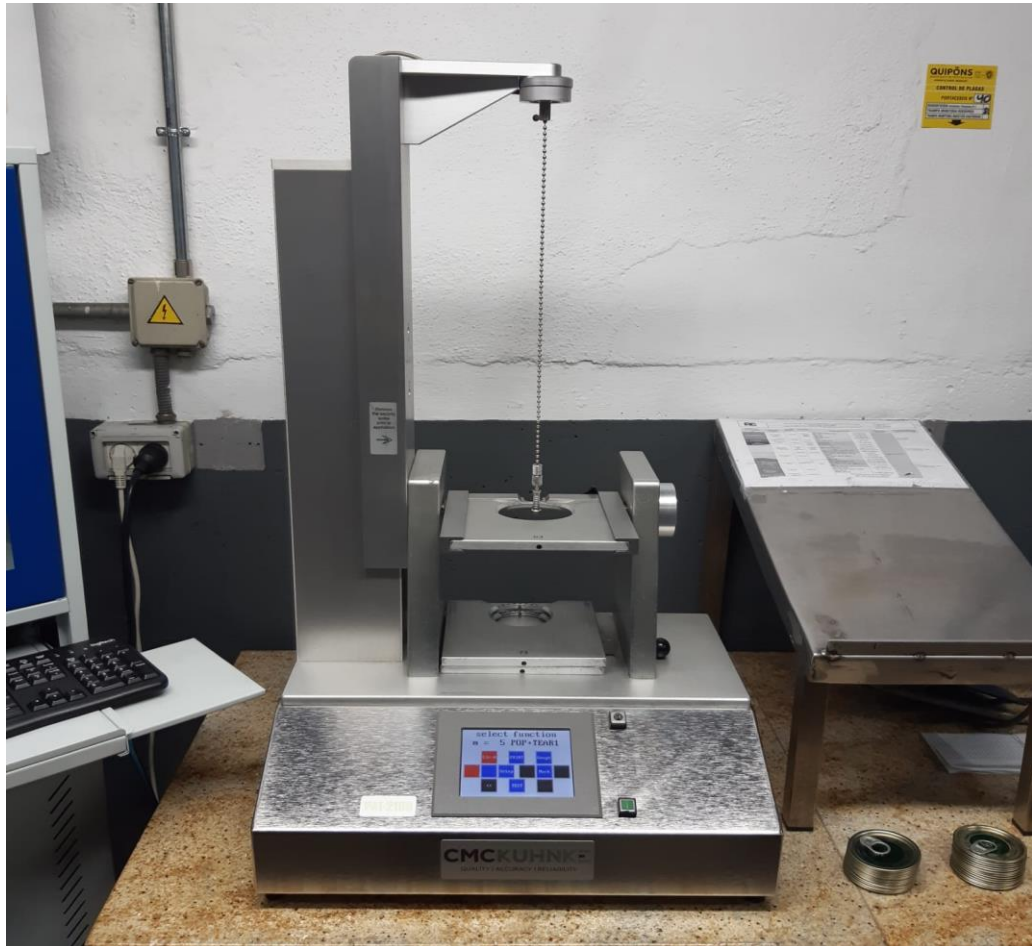
Figura 2. Dinamómetro para tomas Pop y Pull
