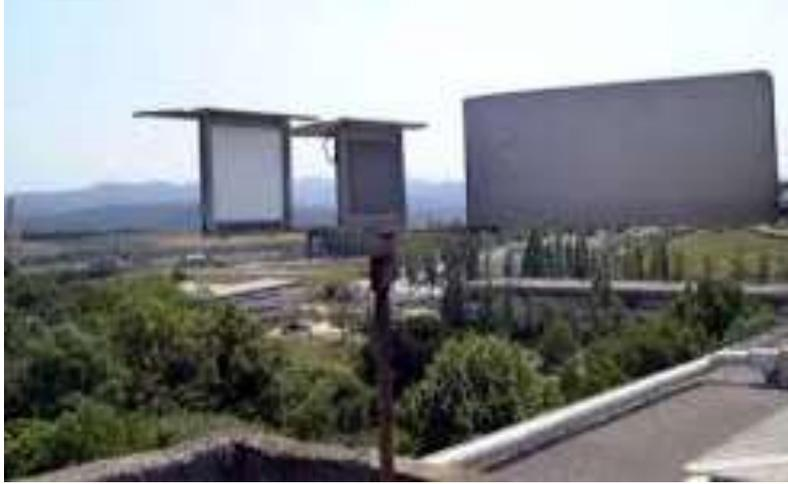
**Figura 2.** Captador tipo Cour. A la derecha la veleta que orienta el dispositivo en la dirección del viento. A la izquierda los dos paneles muestreadores con sus respectivas viseras. Fuente: Laboratori d'Anàlisi Palinològiques, bajo licencia Creative Commons BY-NC-SA 4.0.
