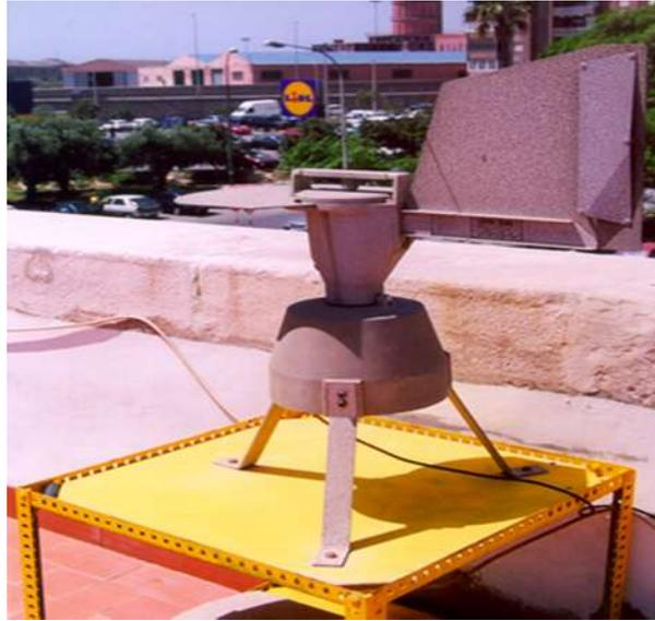
**Figura 1.** Captador tipo Hirst modelo VPPS 2000 de la casa Lanzoni S.R.L., dispositivo empleado para la realización del presente trabajo. Fuente: Grupo de investigación de Aerobiología y Toxicología Ambiental ETSII-UPCT.
