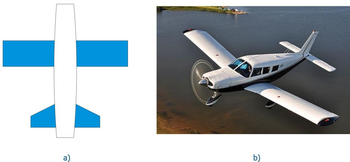
Figura 5.23. a) Configuración de un ala recta de cuerda constante. b) Avioneta Piper PA-32 Cherokee Six.
