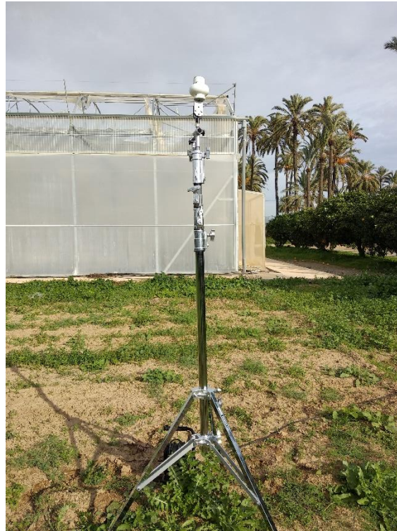
Figura 19. Montaje en trípode de la antena transmisora
