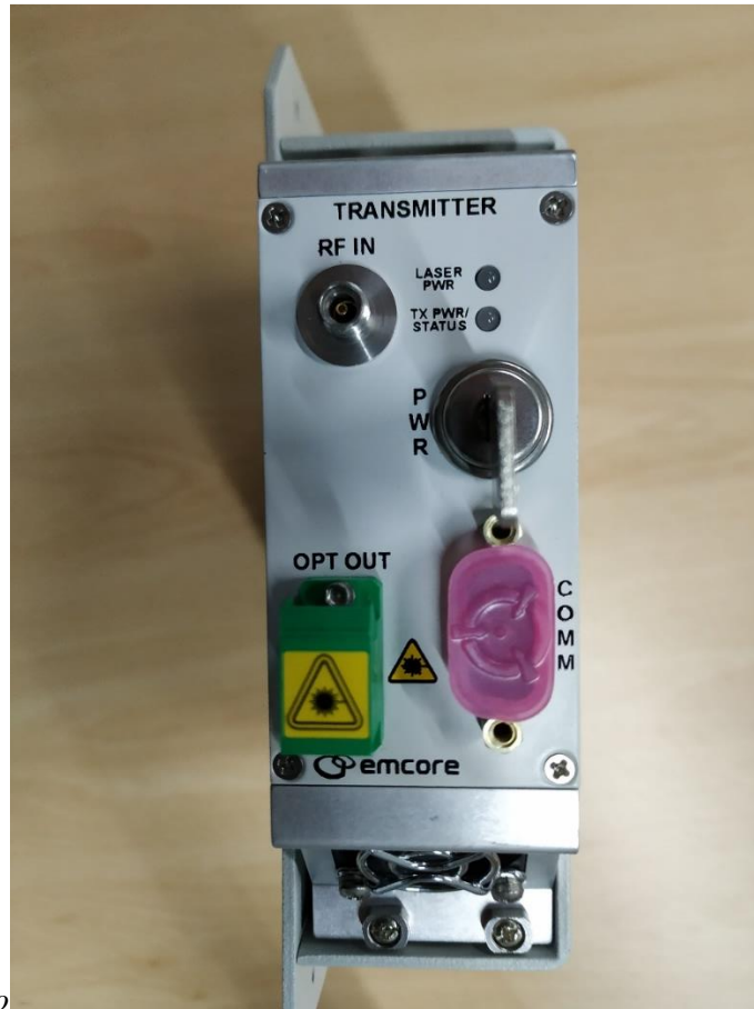
Figura 17. Conversor electro-óptico transmisor
