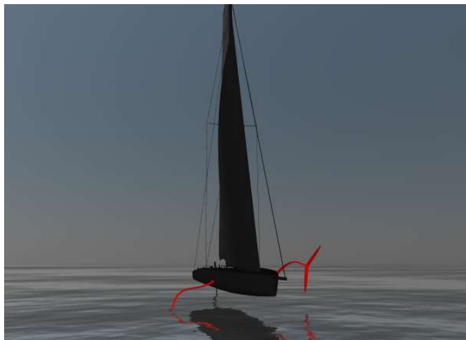
Imagen 3: Foils (en rojo) de un velero AC75 según el mapa interactivo de la web del Emirates Team New Zealand (Copa América)
