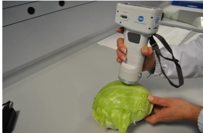
Figura 56. Detalle de la posición de medición de color en la lechuga Iceberg.
