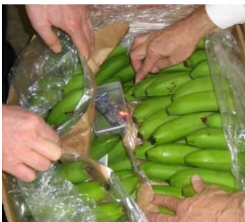
Figura 25. Detalle de los sensores en el interior de la caja de transporte de los platanos (Jedermann et al. , 2011).
