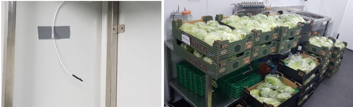
Figura 73. Detalle de los sensores utilizados para la medición de la diferencia dinámica entre la temperatura del aire en la cámara y en el interior de la lechuga.
