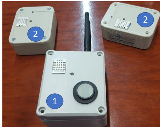
Figura 33. Detalle del nodo Gateway (1) y de dos nodos Slave (2).
