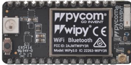
Figura 36. Placa de desarrollo Wipy 3.0 (WiPy 3.0 - Pycom, 2019).
