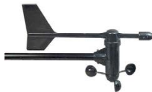
Figura 54. Veleta y anemómetro de una turbina eólica (Fuente: [48])
