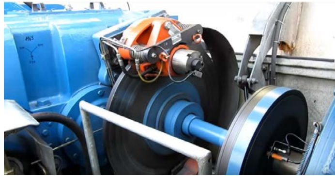
Figura 42. Pinzas y disco del freno mecánico en el eje de alta velocidad (Fuente: Nordex)
