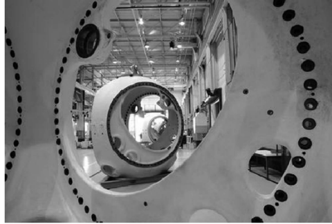
Figura 24. Buje de acero fundido (Fuente: NREL)
