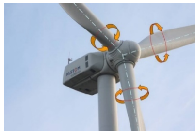
Figura 26. Control del pitch de las palas (Fuente: [29])
