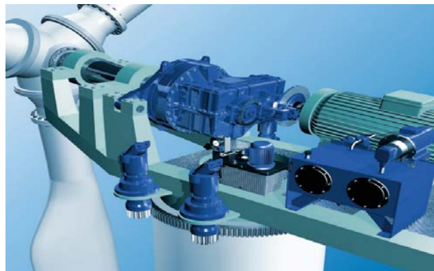
Figura 52. Estructura rígida de la bancada (en verde) (Fuente: [47])
