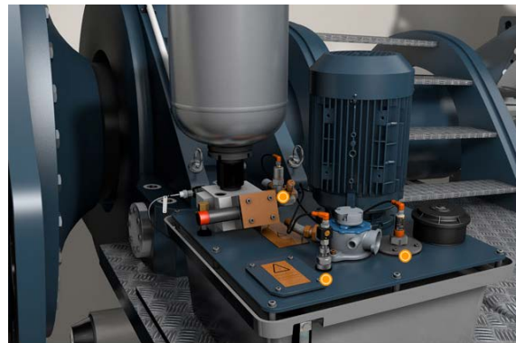
Figura 50. Conjunto de generación hidráulica (Fuente: [42])
