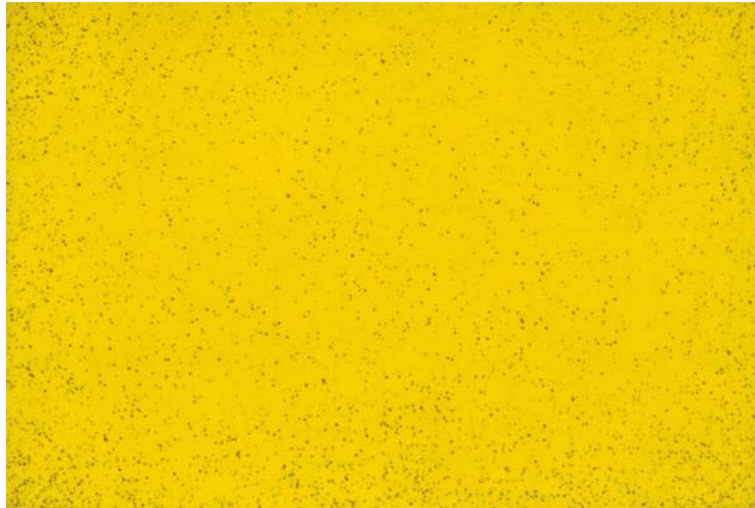
Figura 5. Papel hidrosensible expuesto al arrastre de la corriente de salida de una chimenea solar. (Tiempo de muestreo 30 s.)
