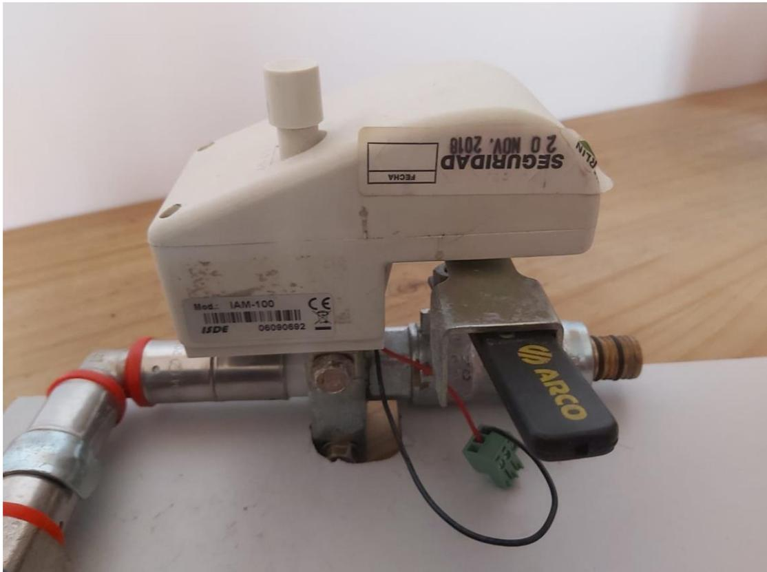
**FIG. 32 - VÁLVULA MOTORIZADA.**
