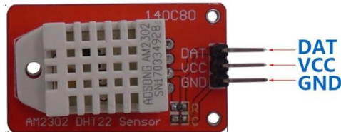
Ilustración 4-5: sensor DHT22 integrado en una PCB y pinout
