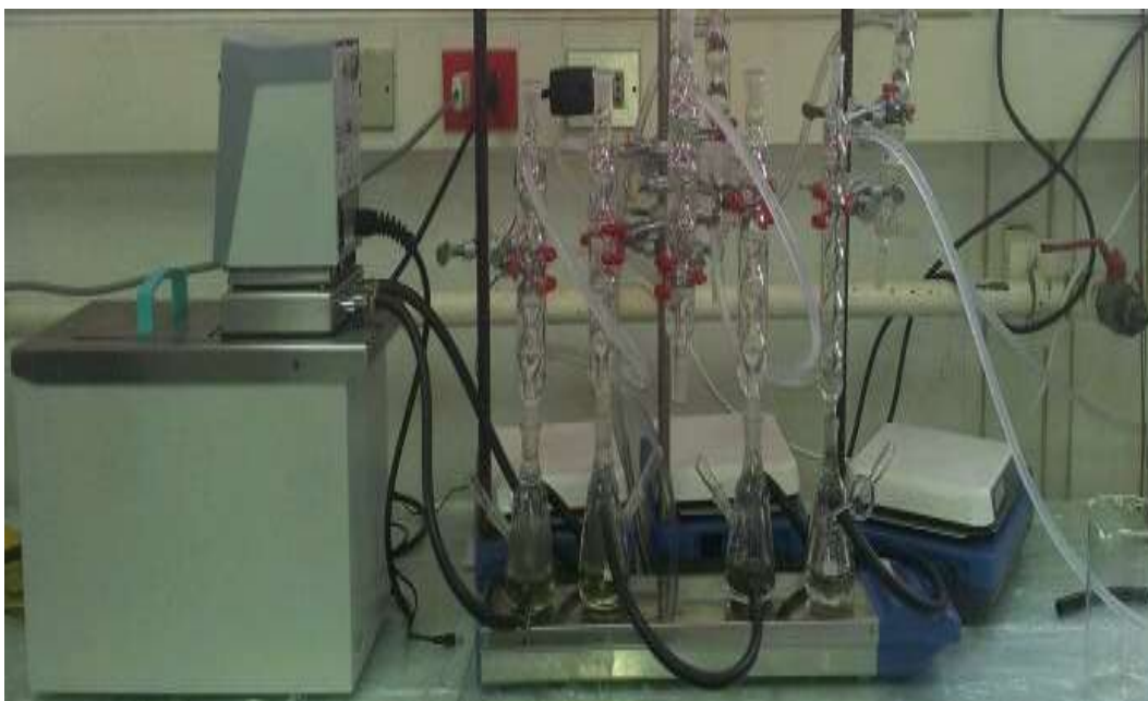
Figura 1 Circuito de reactores en serie (Fuente: Autor)
