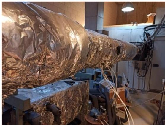
*Ilustración 25 Unidad de Tratamiento de Aire, Conducto de Retorno y Cámara Climática del Circuito de Aire de la Instalación.*
