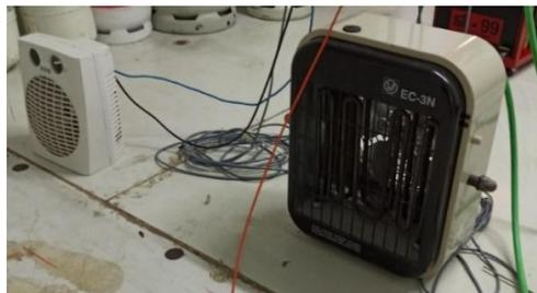
*Ilustración 28 Unidades Auxiliares de Calefacción dentro de la Cámara Climática.*
