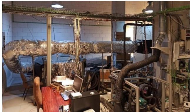
*Ilustración 19 Fotografía del Circuito de Refrigerante y Circuito de Aire de la instalación.*
