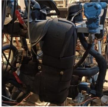
*Ilustración 23 Intercambiador Agua-Refrigerante del Circuito de Refrigerante.*
