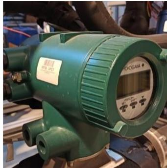
*Ilustración 35 Caudalímetro de tipo Coriolis instalado en el Circuito de Refrigerante.*
