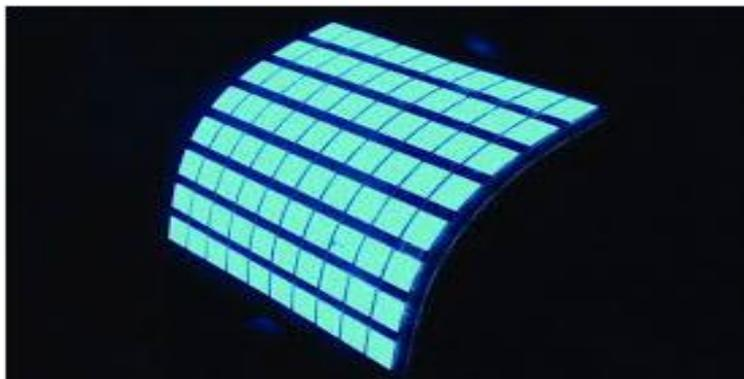
Figura 02. Diodo que se basa en una capa electroluminiscente.
