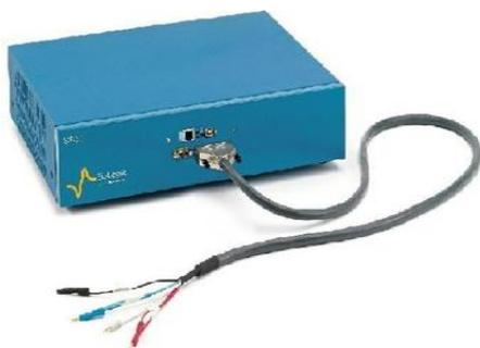
Figura 19. La estación de medida de cuatro puntas SP-50.
