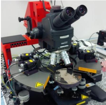
Figura 20. Estación de medida de cuatro puntas Suss Microtech EP-4.
