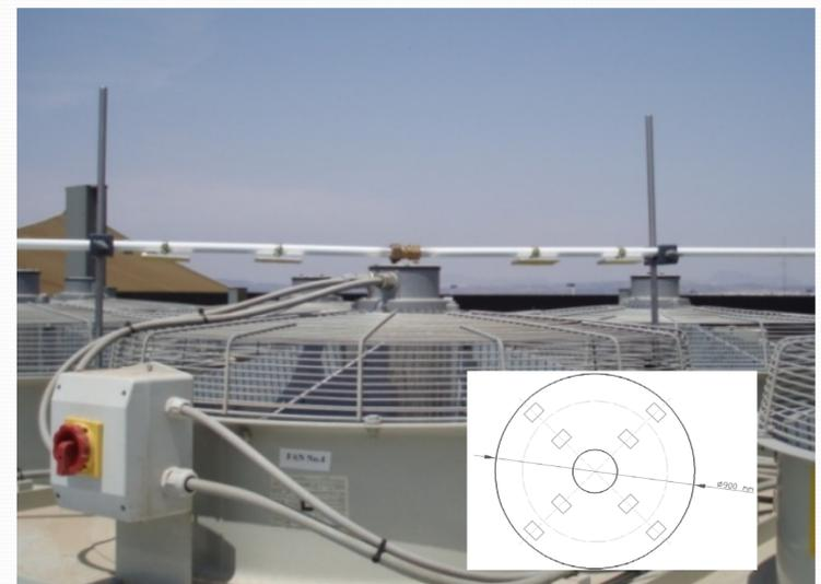
Detalle de la medida del arrastre con papel hidrosensible en la sección de salida del Aero-refrigerador
