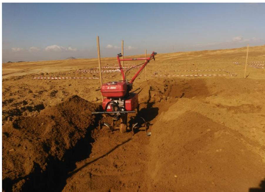
Figura 6. Motoazada para homogeneización residuo.
