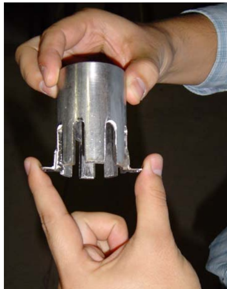
Figura 5. 1-Campana de un plato de la torre de destilación.
