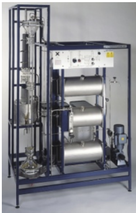
Figura 3. 3-Equipo de extracción líquido-líquido UOP 5 de Armfield.
