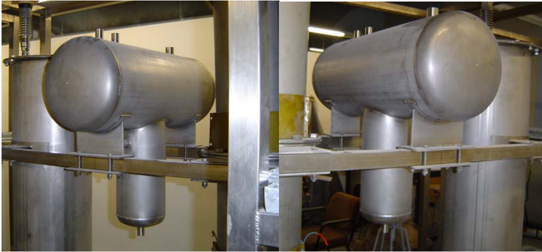
Figura 5. 17- Decantador partes delantera y trasera.
