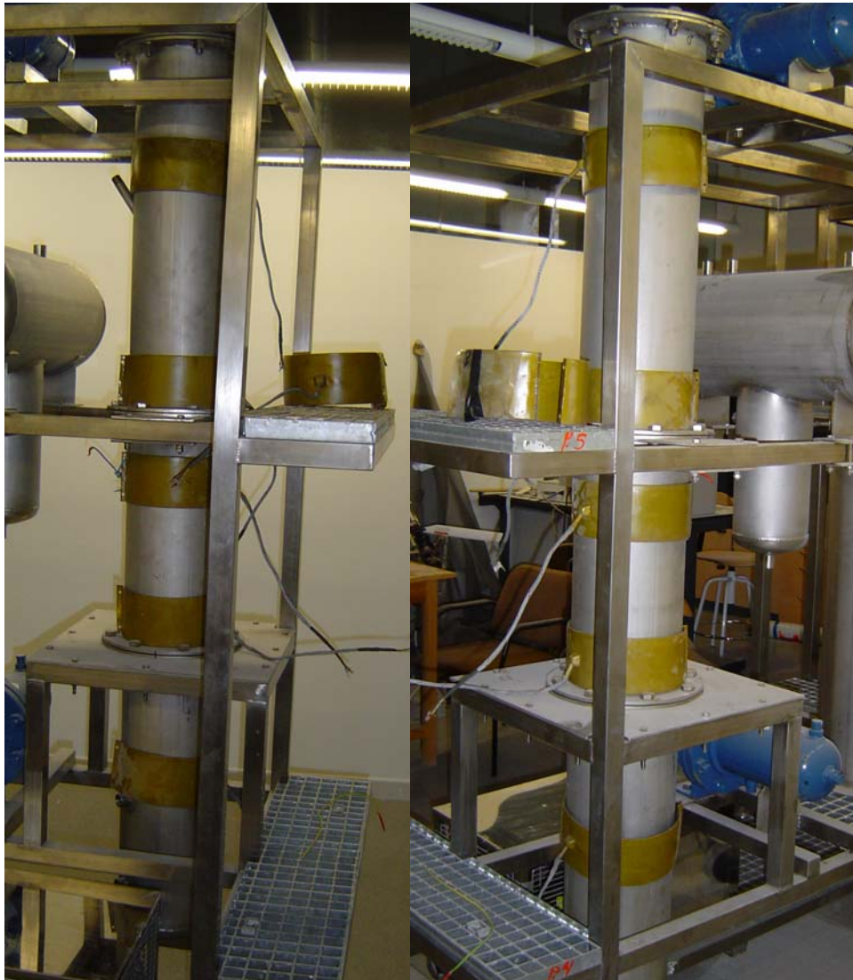
Figura 5. 21- Columna de destilación partes delantera y trasera.
