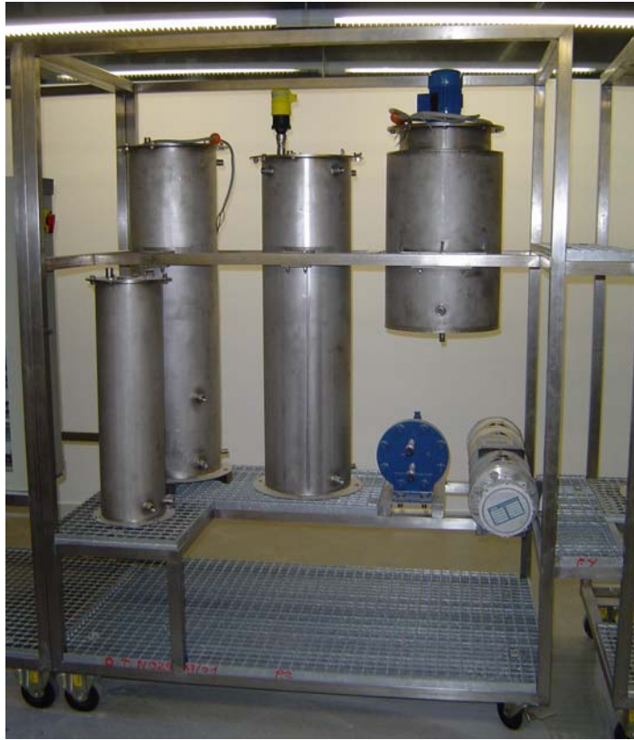
Figura 5. 24- Bastidor Reactor Químico y accesorios.
