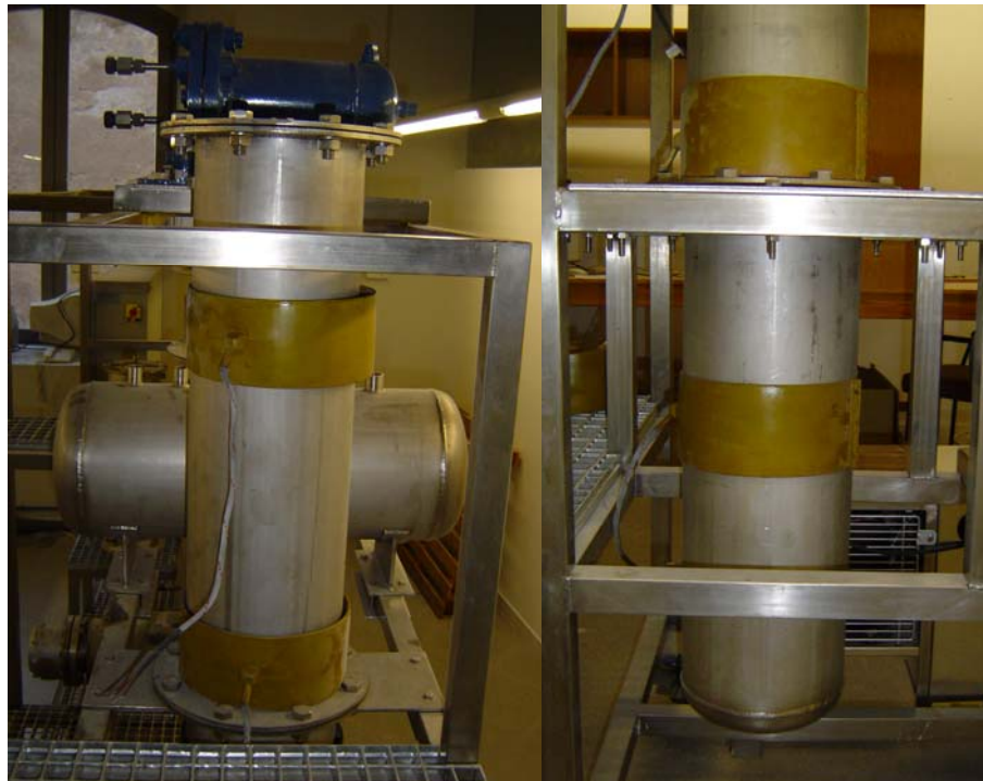
Figura 5. 20- Detalle de resistencias en cabeza y fondo de columna.
