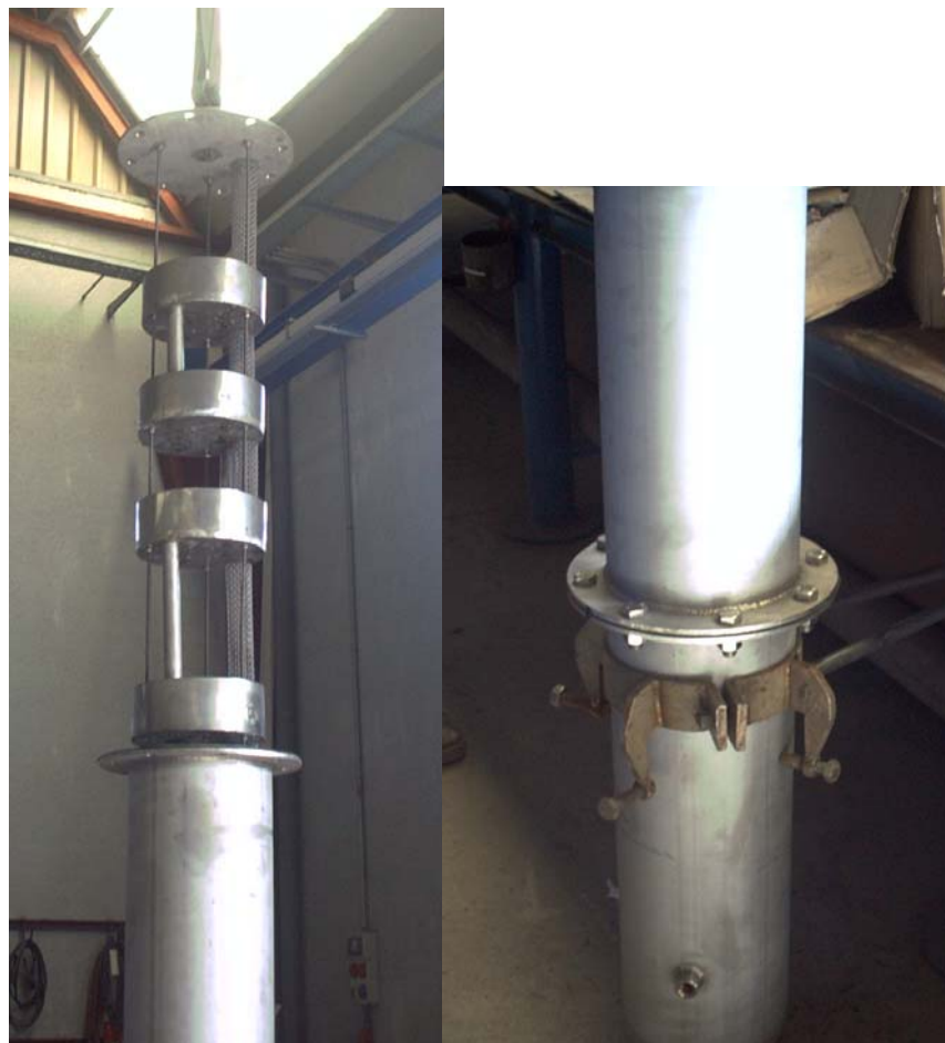
Figura 5. 8- Columna en fase de fabricación. Partes superior e inferior.
