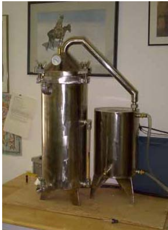
Figura 1. 1- Columna de destilación portátil de laboratorio.
