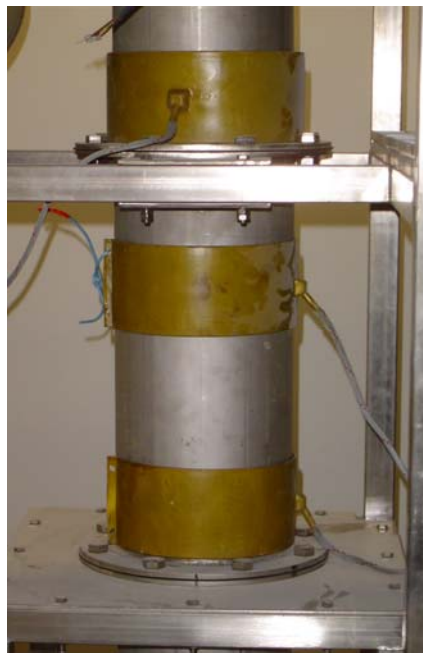
Figura 5. 12-Detalle de resistencias abrazando la columna.
