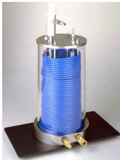
Figura 3. 5-Reactor tubular CE 310.02 de Gunt.
