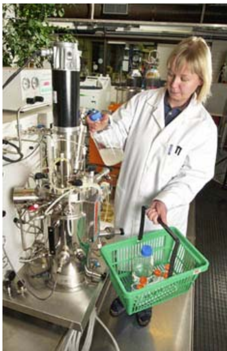
Figura 1. 2-Pequeña planta piloto de fermentación
