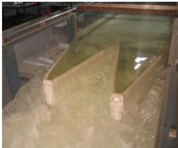
Figura 5. Aliviadero tipo laberinto con perfil “Half-Round”, \alpha = 12^\circ y HT/P = 0.196 utilizado por Crookston en su investigación. Fuente: Crookston (2010).
