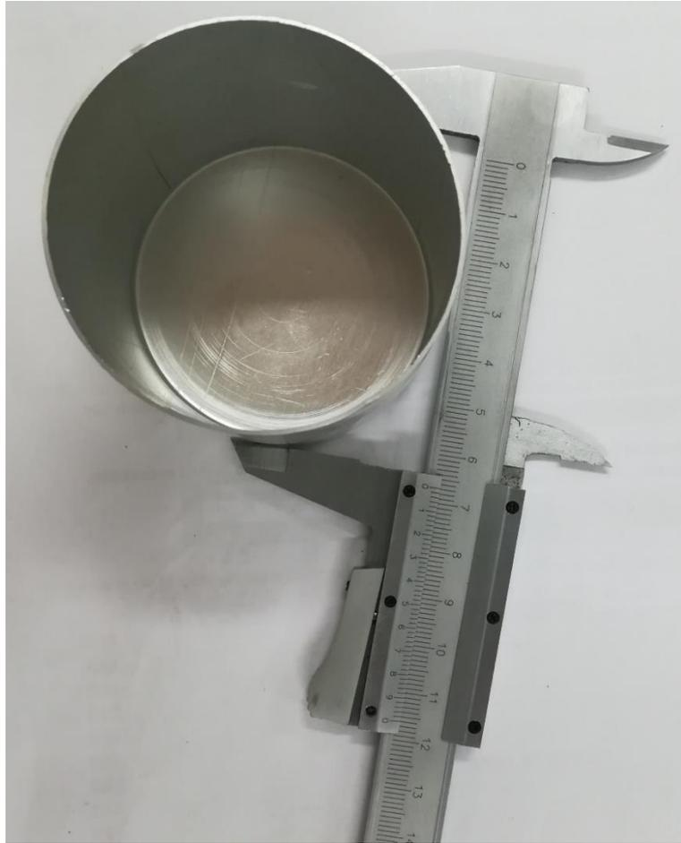
Figura 4.11 Recipiente empleado en ensayo densidad mínima y pie de rey.
