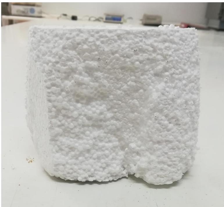
Figura 4.16 Muestra de EPS con densidad  $20 \text{ kg/m}^3$
