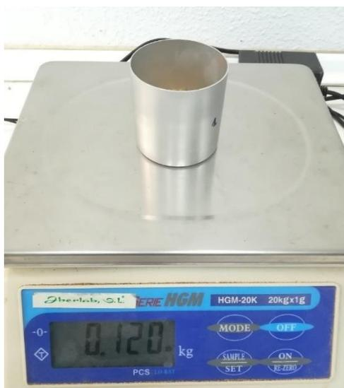
Figura 4.14. 120g de muestra para densidad máxima método 2
