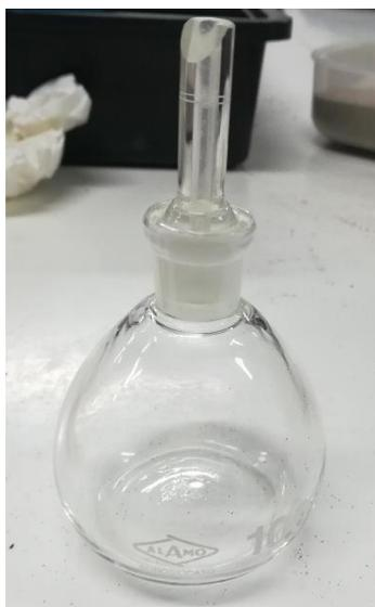
Figura 2.6 Picnómetro para la realización del ensayo Gs.
