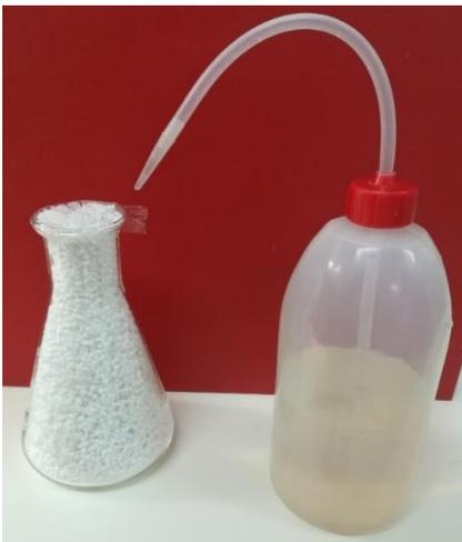
Figura 4.20 Llenado de la muestra con agua
