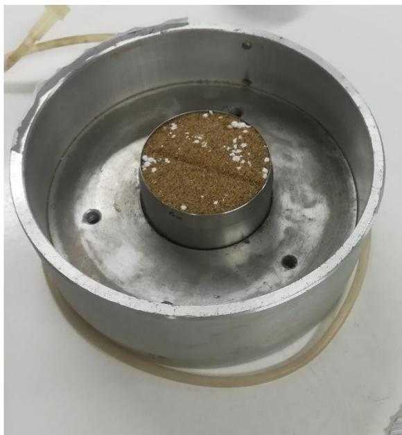
Figura 5.1 Muestra de arena y EPS en anillo edométrico
