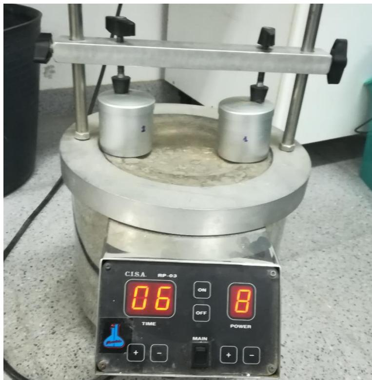
Figura 4.15. Vibrado para obtener densidad máxima método 2
