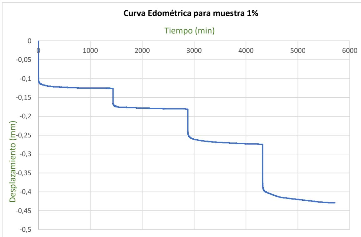
Figura 5.6. Curva edométrica 1 con muestra 1% EPS
