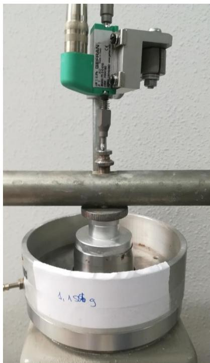
Figura 5.2 Célula edométrica y transductor colocado.
