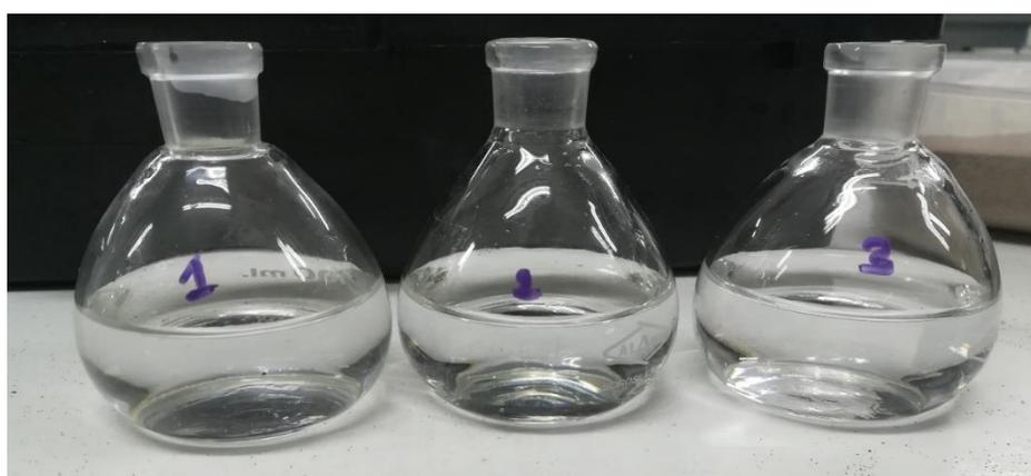
Figura 4.7. Picnómetros con la mitad de agua
