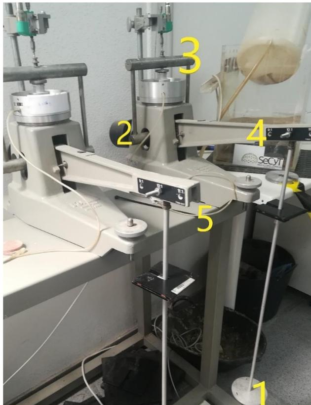
Figura 3.5. Bancada Edómetro del laboratorio de Geotecnia
