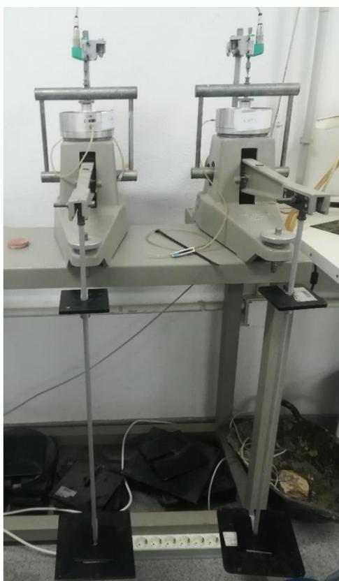
Figura 5.3. Edómetro en funcionamiento.
