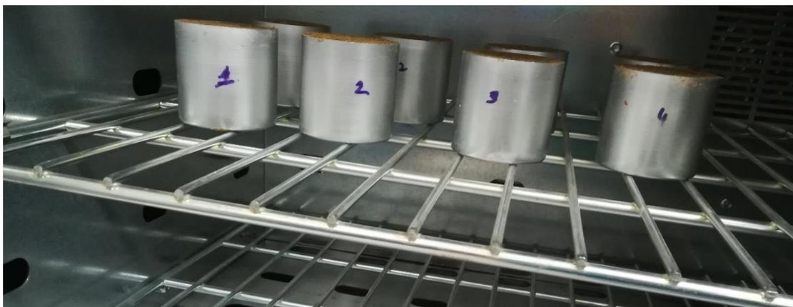
Figura 4.13 Muestra de arena dentro de estufa
