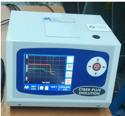
Figura 3.3Maquina para registro de datos Metatest
