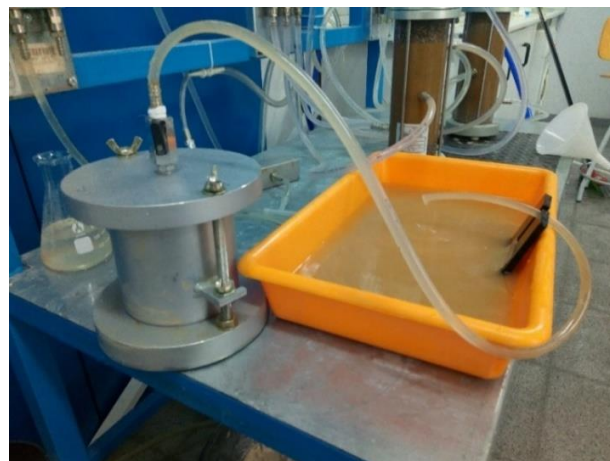
Montaje del sistema. Detalles del teflón y la turbidez del agua.
