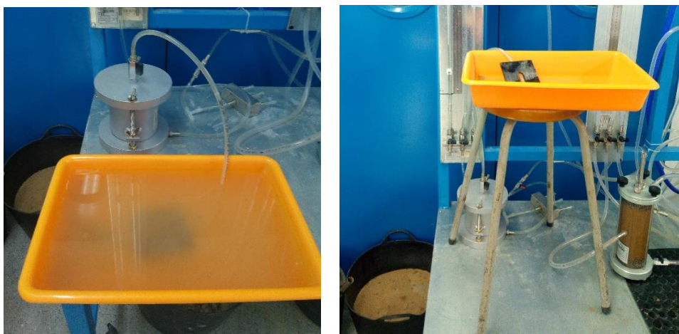
Diferencia de nivel del recipiente de desagüe entre los dos tipos de ensayo
