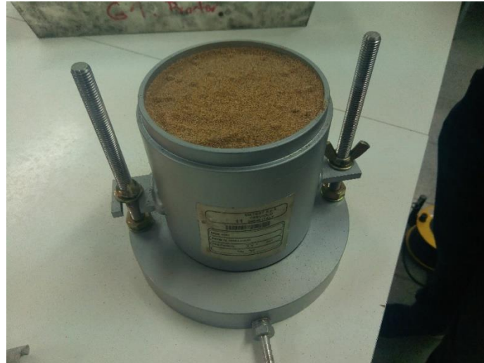
Estado final del permeámetro antes de cerrarlo
