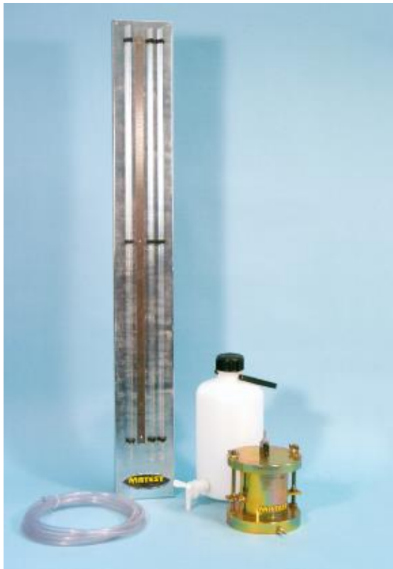
Componentes del permeámetro de carga variable que tenemos
