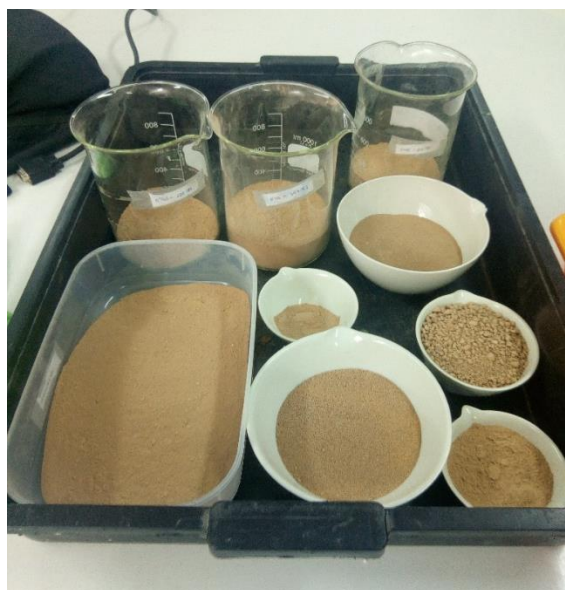
Separación del limo en diferentes recipientes según su tamaño
