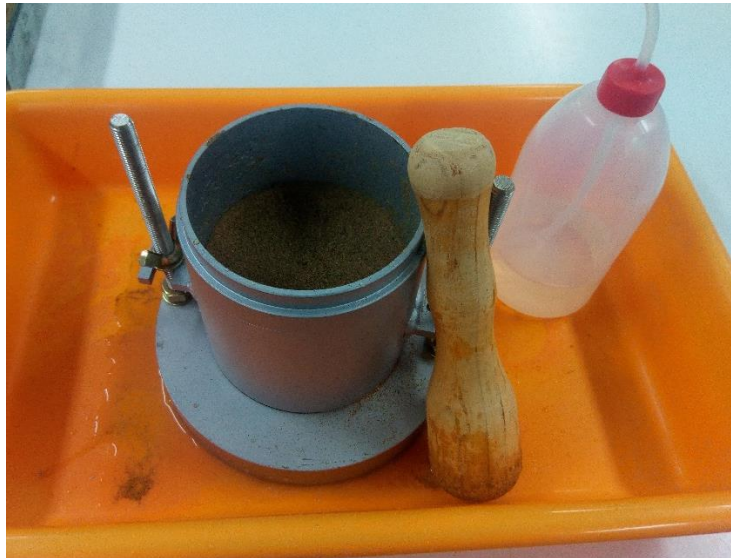
Maza y agua con la que compactamos la arena.
