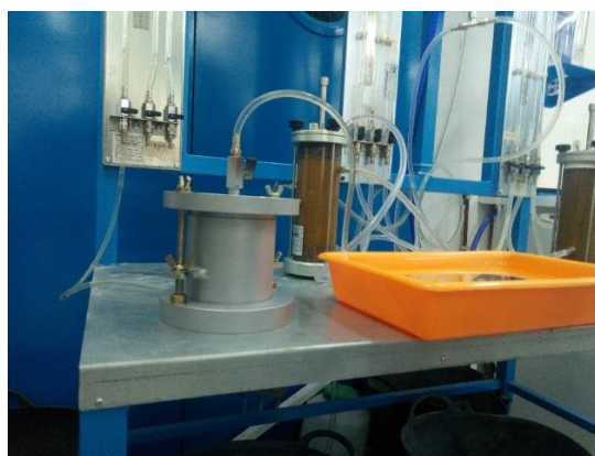
Montaje de la prueba de estanqueidad.
