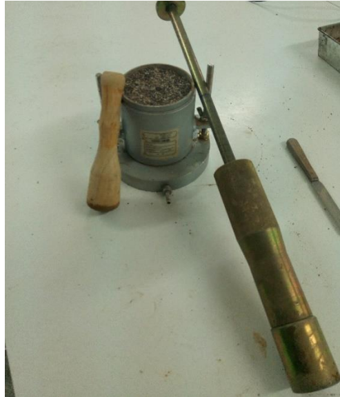
Acabado con la grava del permeámetro y pisón del Proctor
