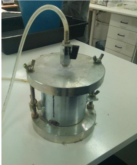
Estado inicial del permeámetro
