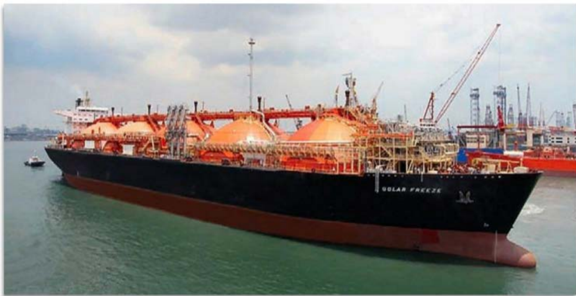
Figura 11. Buque con tanques esféricos tipo Moss Rosenberg
