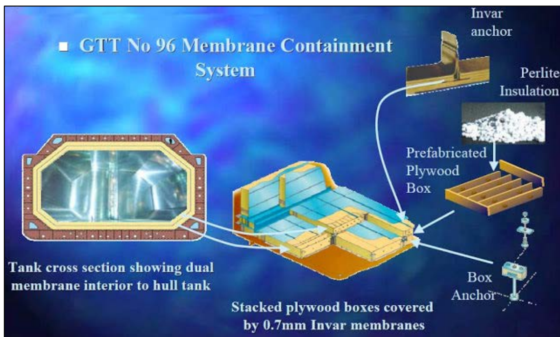
Figura 18. Sistema de aislamiento de membrana No 96
