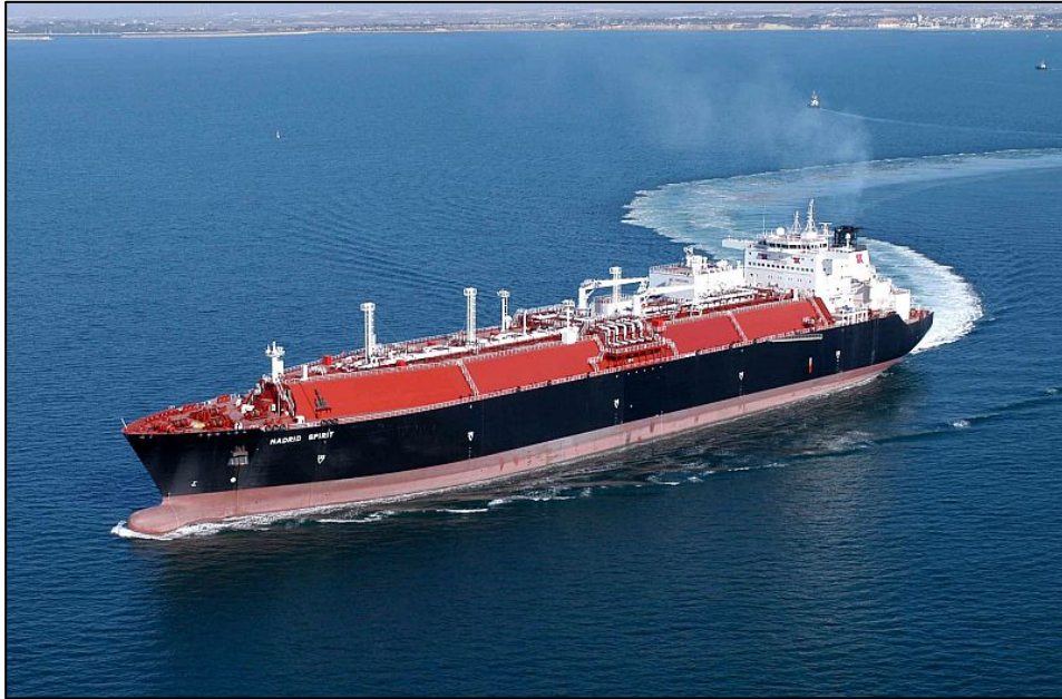
Figura 15. Buque LNG de tipo membrana
