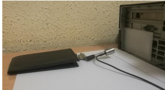
Figura 46: Medición de ruido con el panel de material PLA.
