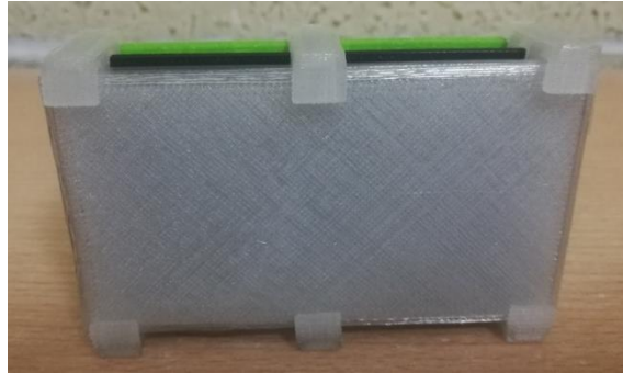
Figura 34: Prototipo hipótesis 3 con combinación PLA / ABS-PLUS / FILAFLEX.
