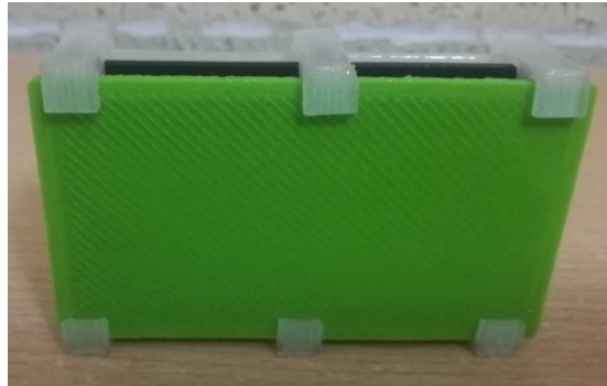
Figura 38: Prototipo hipótesis 3 con combinación FILAFLEX / ABS-PLUS / PLA .
