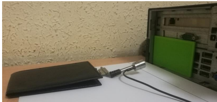
Figura 48: Medición de ruido con el panel de material FILAFLEX.
