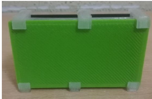
Figura 40: Prototipo hipótesis 3 con combinación FILAFLEX / PLA / ABS-PLUS.
