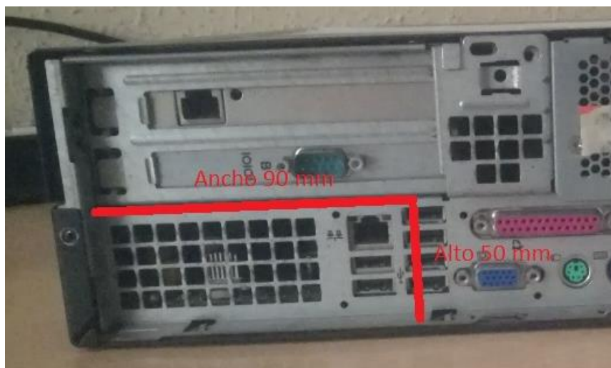
Figura 8: Dimensiones establecidas para el diseño de los paneles.
