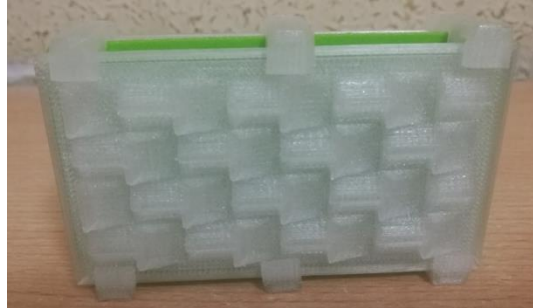
Figura 32: Prototipo hipótesis 2 con panel central FILAFLEX.
