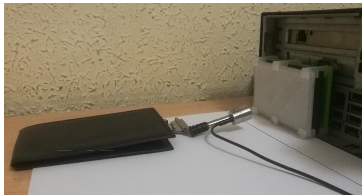
Figura 39: Medición de ruido con el prototipo de la figura 38.
