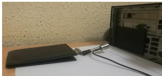
Figura 47: Medición de ruido con el panel de material ABS-PLUS.
