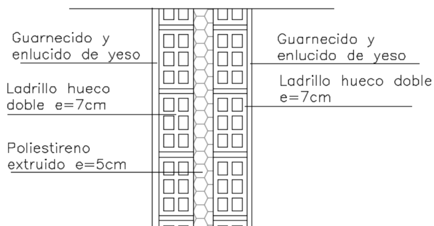
Medianera entre viviendas y zonas comunes del edificio.
