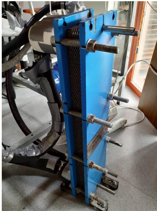
Figura 2. 4. Intercambiador de calor del circuito secundario.
