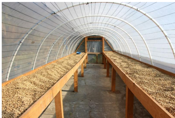
Imagen 5. Secadero solar pasivo directo de tipo invernadero.
