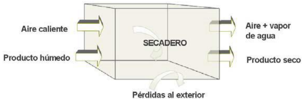
Figura 16. Esquema genérico de un proceso de secado.
