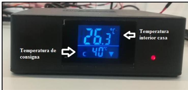
Figura 83. Temperaturas de consigna e interior de la casa ensayo 40°C.
