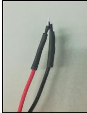
Figura 45. Soldaduras recubiertas con material termo-retráctil.
