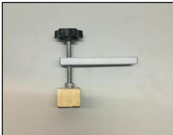
Figura 9. Pletina de acero con tornillo moleteado y taco pequeño de madera.
