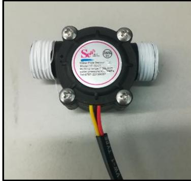
Figura 54. Teflón aplicado en los extremos del sensor de caudal.
