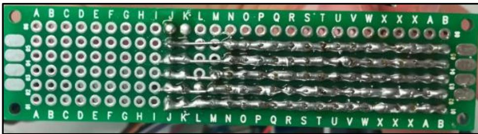
Figura 41. Soldadura de conectores Dupont hembra en Stripboard.
