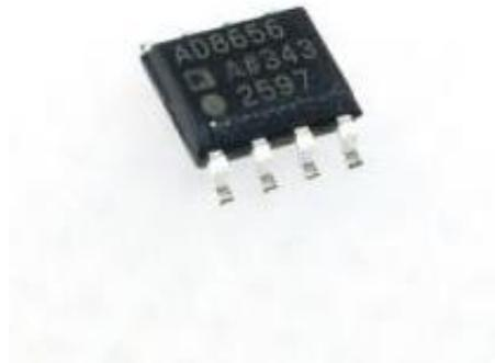
Figura 21 - Circuito integrado AD8656
