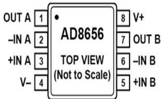
Figura 50 - Conexiones del circuito integrado AD8656
