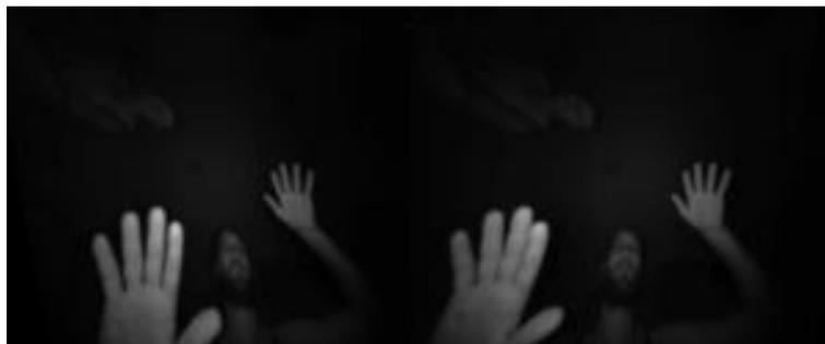
*Figura 44 - Imágenes capturadas por el dispositivo Leap Motion*
