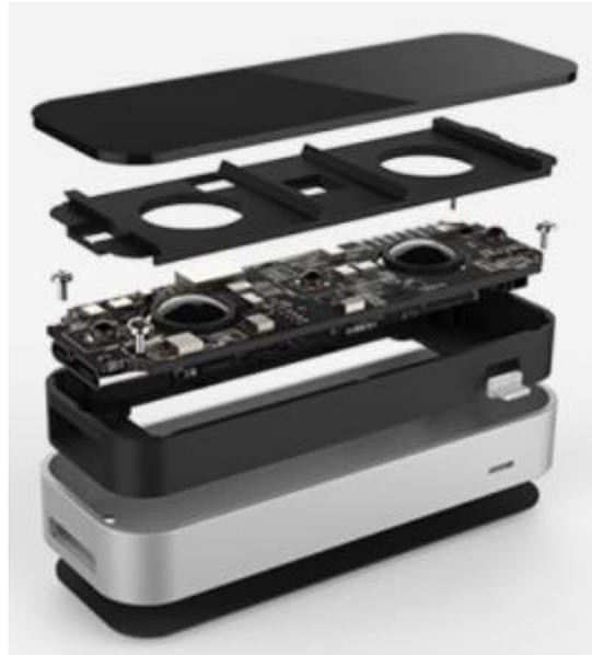
*Figura 40 - Dispositivo Leap Motion desmontado*
