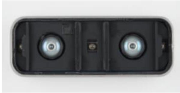
*Figura 41 - Cámaras del dispositivo Leap Motion*
