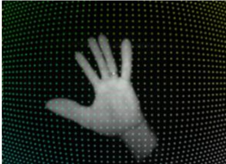
*Figura 45 - Mallado del dispositivo de Leap Motion*
