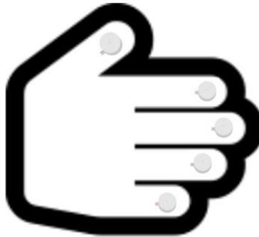
*Figura 26 - Disposición de los vibradores en el guante háptico*
