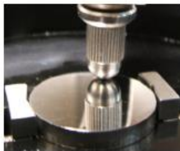
Figura 12. Contacto acero inoxidable AISI 316L/zafiro
