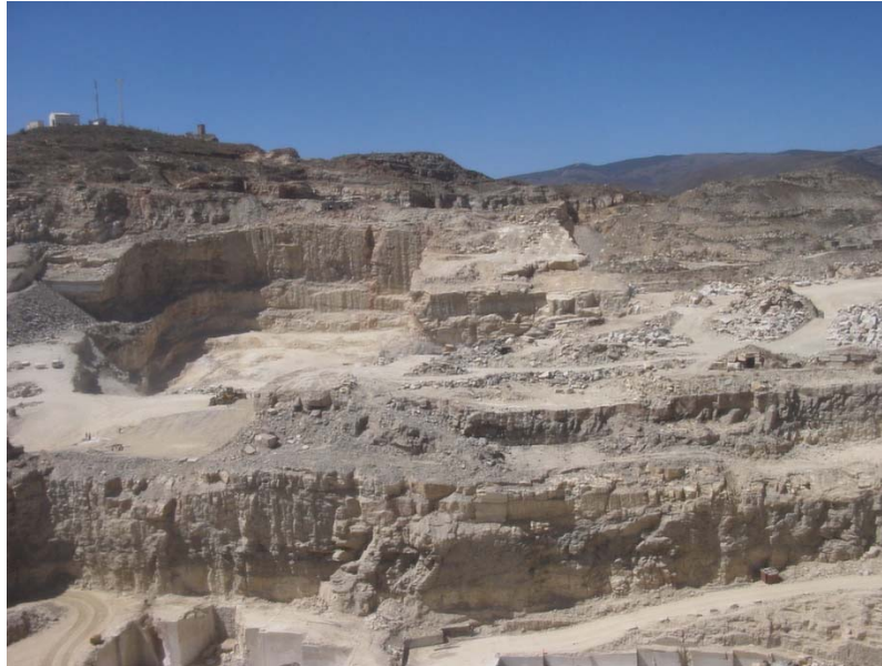
figura 2.5. Capa de esquistos recubriendo el mármol en Macael (Trigueros et al, 2011).
