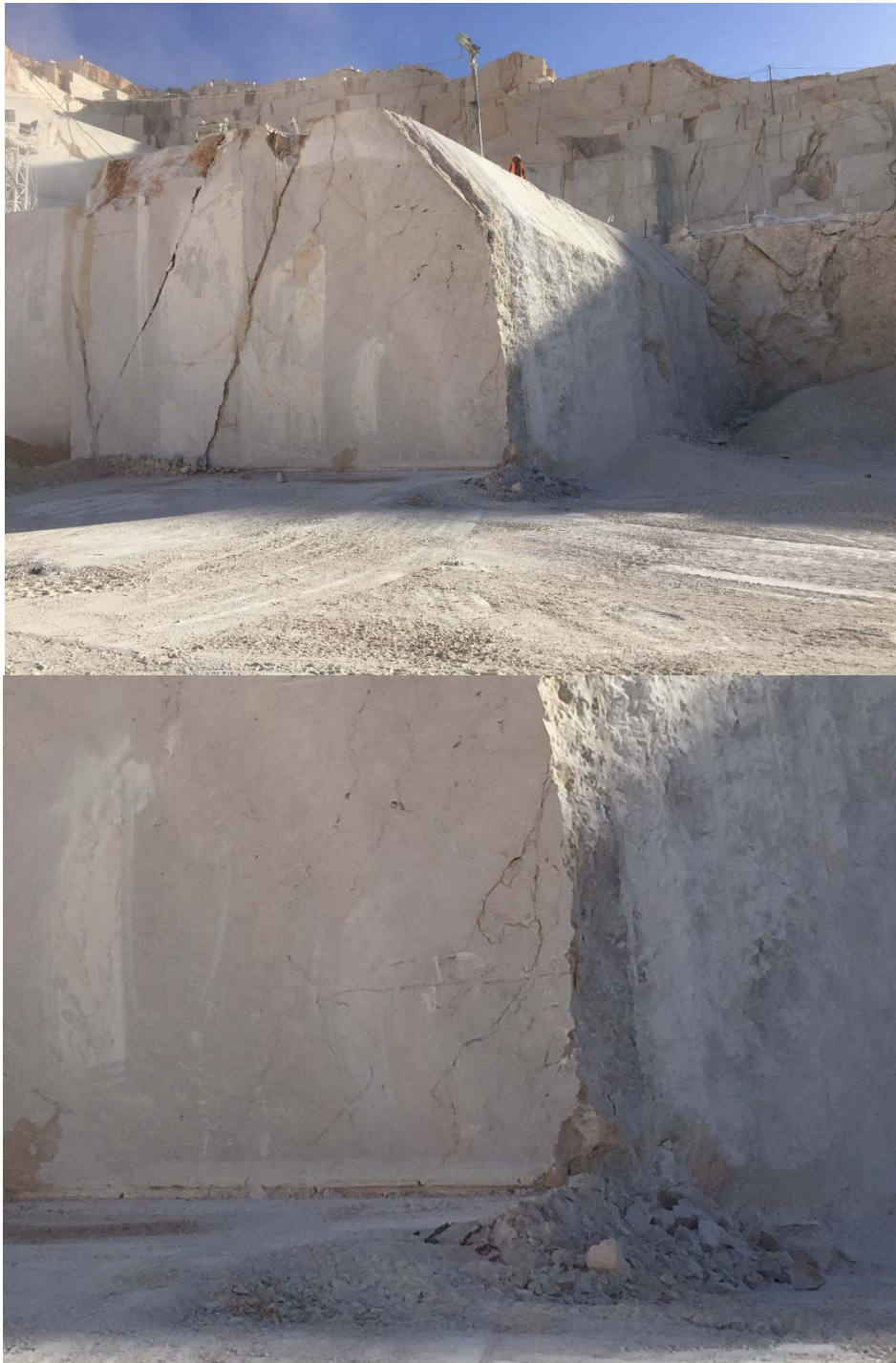
figura 6.19. Resultado del nuevo método de entrada con voladura. Pequeña aureola de fisuras en la base, de algunos decímetros.
