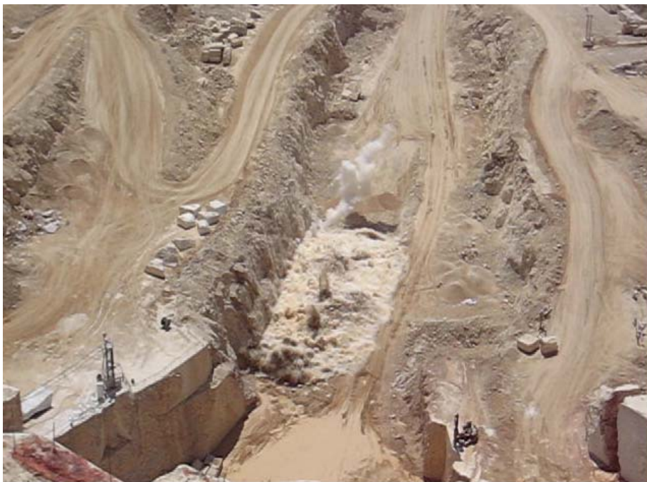
figura 2.6. Voladura en zanja para accesos a bancos inferiores en Monte Coto, Pinoso (Trigueros et al, 2011).
