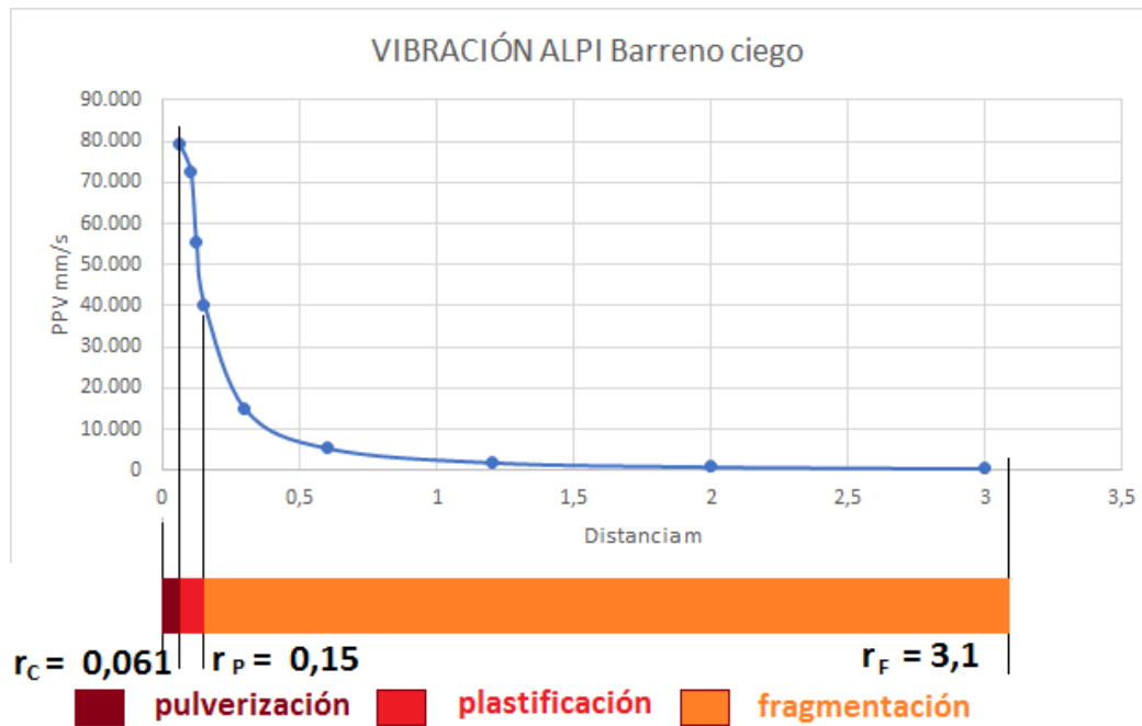
figura 6.12. Alpi: vibraciones alrededor de un barreno ciego de 10 kg de explosivo
