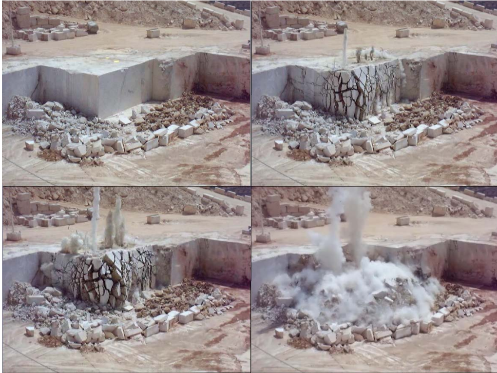
figura 2.7. Voladura con levante en Monte Coto, Pinoso (Trigueros et al, 2011).
