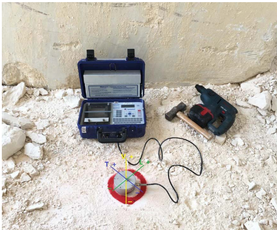
figura 4.7. Equipo de registro con geófono anclado a roca (cantera Marcotsa).
