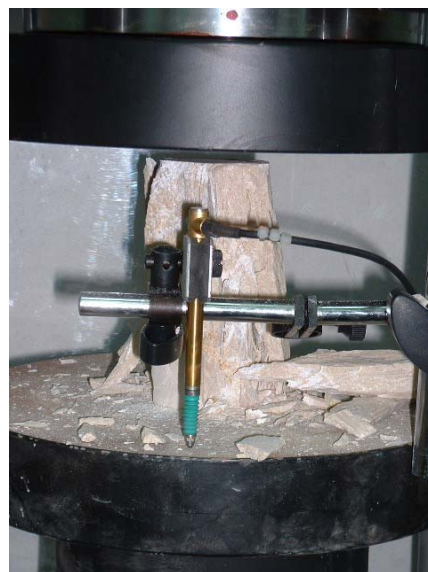
figura 5.5. Probetas para ensayos mecánicos MARCOTSA. Ensayo uniaxial con módulos.
