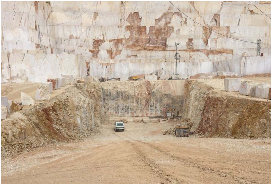
figura 6.17. Procedimiento habitual de entrada en capa. Voladura con precorte y rozado.
