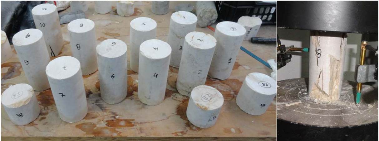
figura 4.10. Ensayos mecánicos sobre probetas de roca (cantera Alpi).
