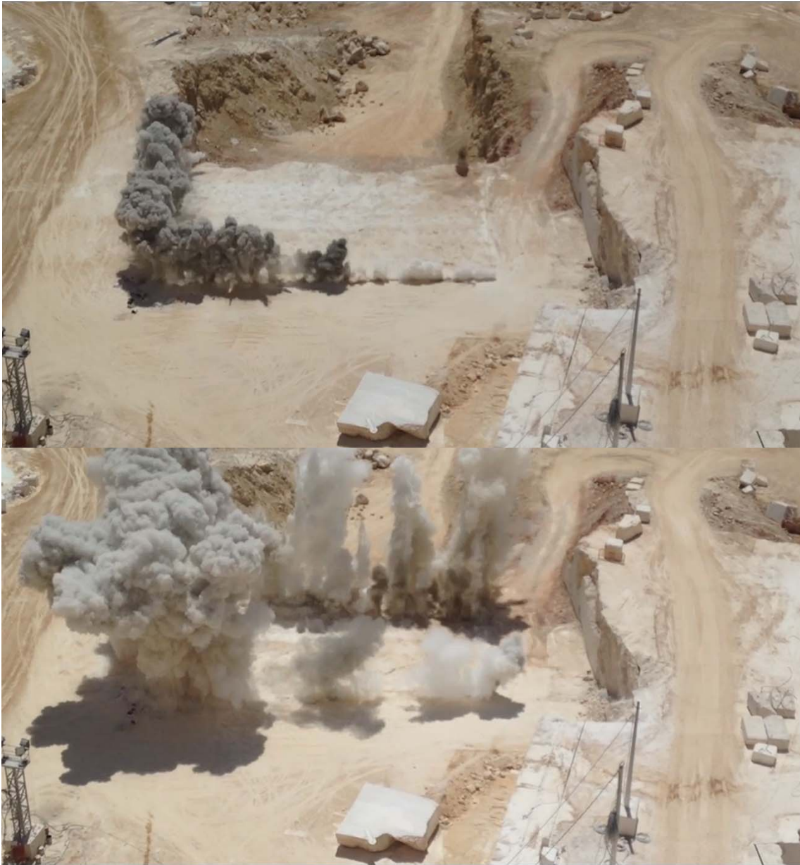
figura 6.18. Nuevo método de entrada directa en capa. Voladura con precorte previo.
