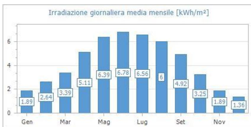
**Figura 42:** irradiación media diaria mensual en el plano horizontal [kWh / m²] - Fuente de datos: UNI 10349: 2016 - Estación de detección: Nocera Inferiore
