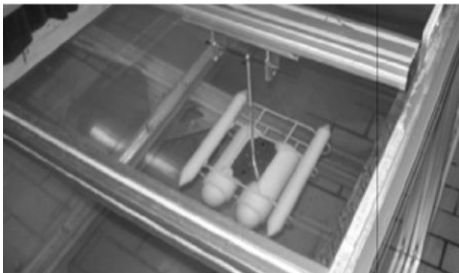
Figura 2-2. Prototipo de ROV en un tanque de agua para ensayos empírico. (Fuente: (Chin & Lau, 2011))
