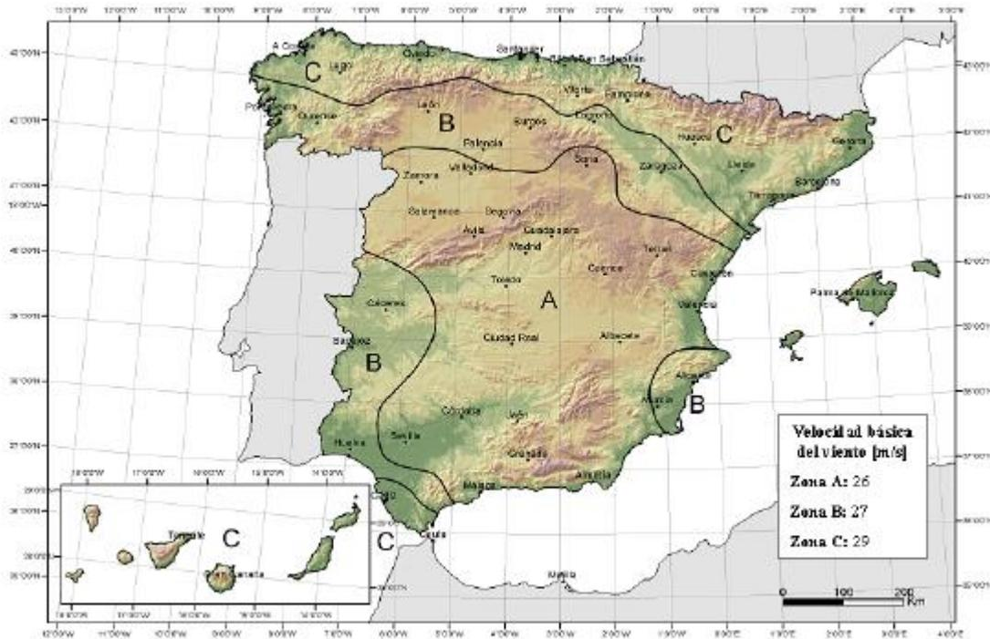
**Figura 17. Valor básico de la velocidad del viento. Fuente: CTE-DB - SE-AE**
