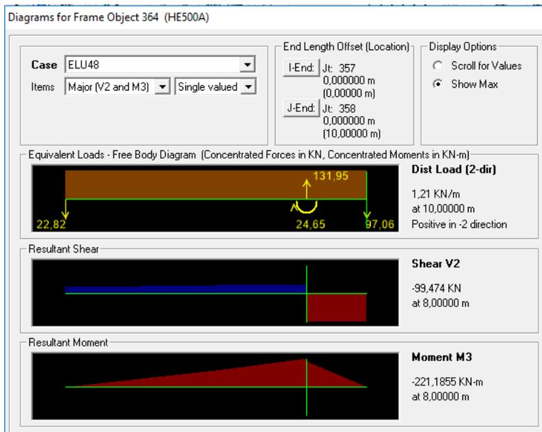
Figura 68. Diagrama de esfuerzos en pilares interiores
