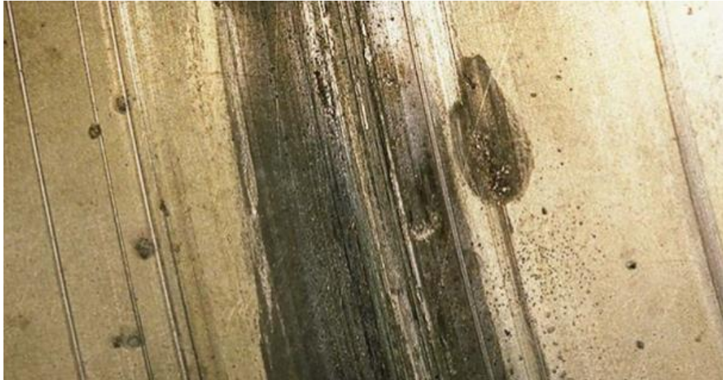
Figura 4. Ejemplo de desgaste abrasivo producido en cojinetes.
