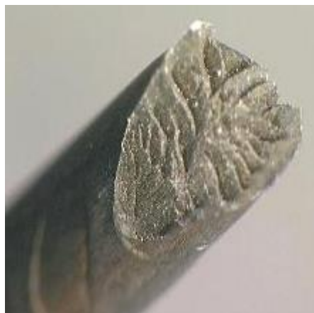
Figura 5. Desgaste por fatiga.
