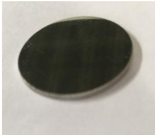
Figura 10. Disco de acero AISI 316L utilizado en los ensayos.
