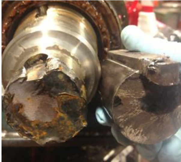
Figura 7. Desgaste por corrosión.
