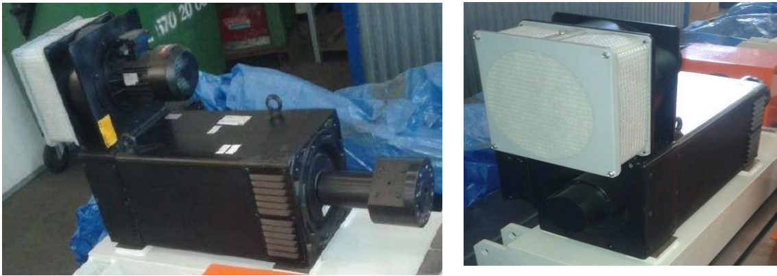
.Freno eléctrico asíncrono ABB 160-152 kW-400V TVC160L5. Izquierda: visión de conjunto. Derecha: detalle del ventilador auxiliar.
