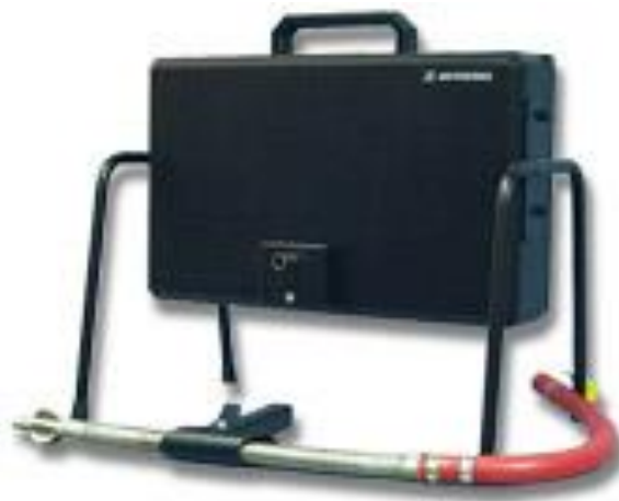
Ilustración23. Opacímetro Motorsens M-170 usado en la experimentación.
