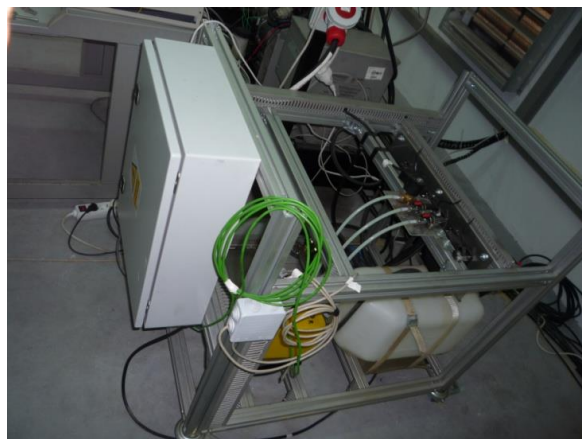
Ilustración15. Banco de medición del consumo de combustible.
