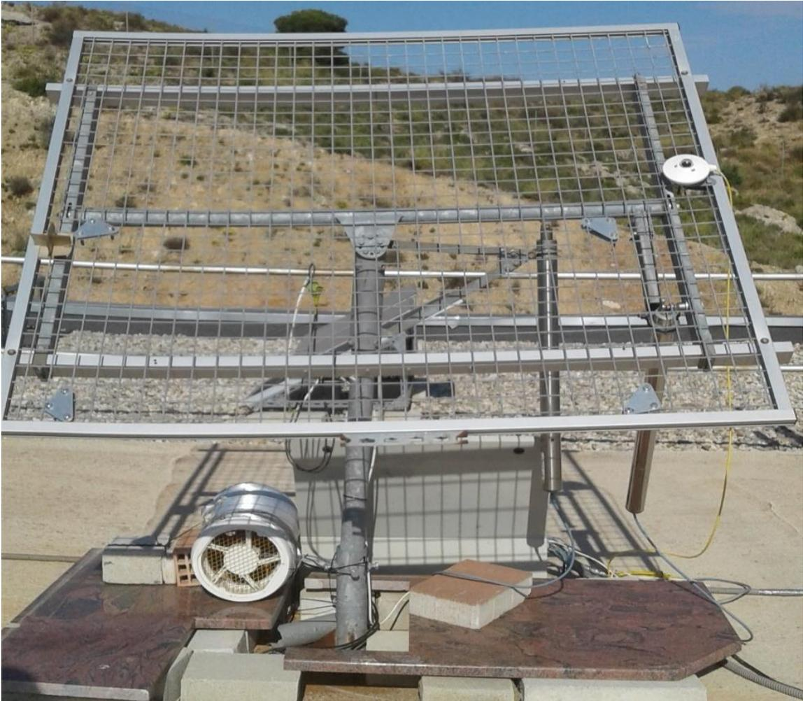
*Figura 15. Seguidor solar de dos ejes con ambos motores instalados y funcionando.*
