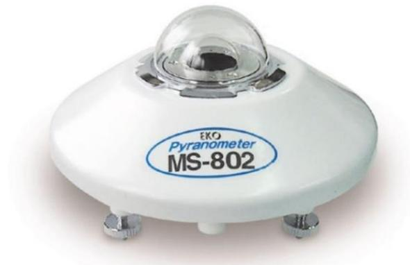
*Figura 4. Piranómetro, instrumento utilizado para medir la radiación solar global (EKO Instruments MS-802).*
