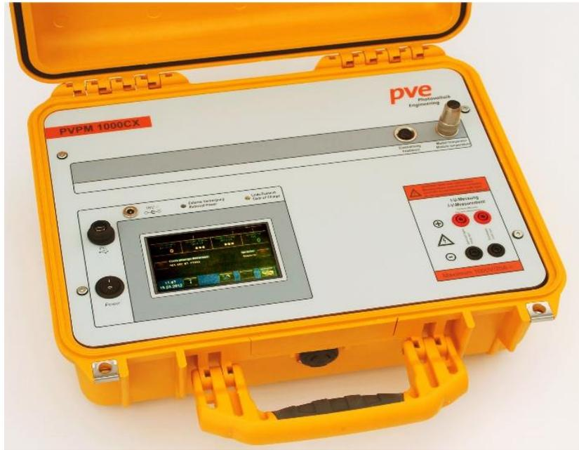
*Figura 19. Trazador de curvas I-V (Adler PVPM 1000CX).*
