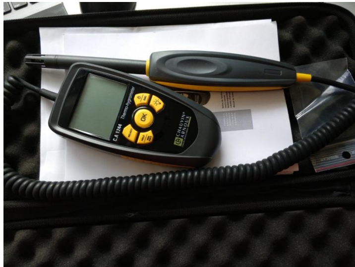
Figura 6.13 Sonda para calibrar los sensores de temperatura.
