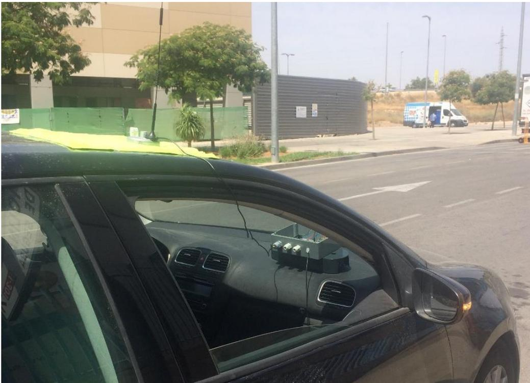
**Figura 10.** OBU instalado en el automóvil
