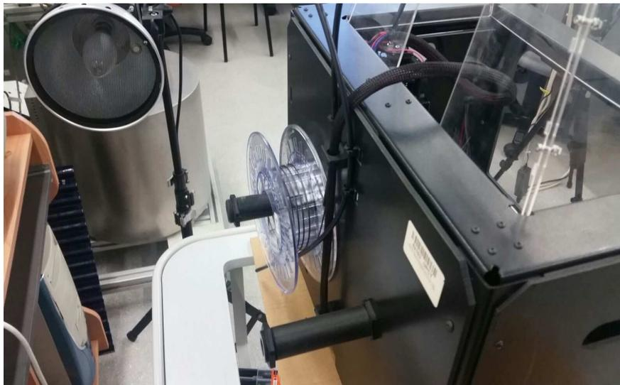
Figura 2-11. Zona de colocación de la bobina de material en la impresora LEMONBOT.
