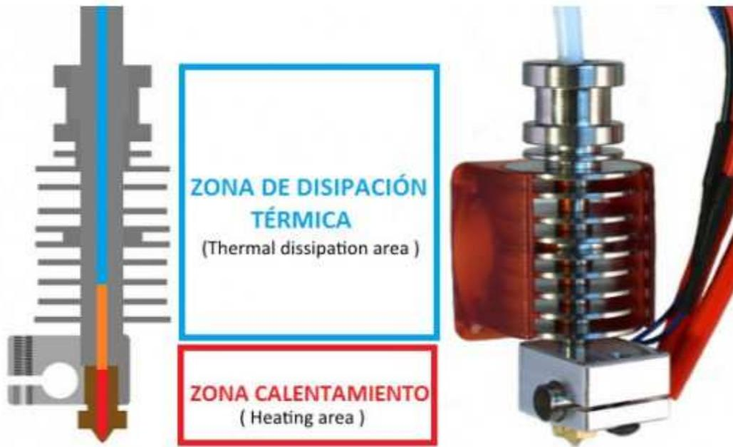
Figura 1-6. Zonas del cabezal o extrusor [23].
