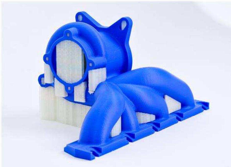
*Figura 1-14. Pieza con material de soporte [27].*
