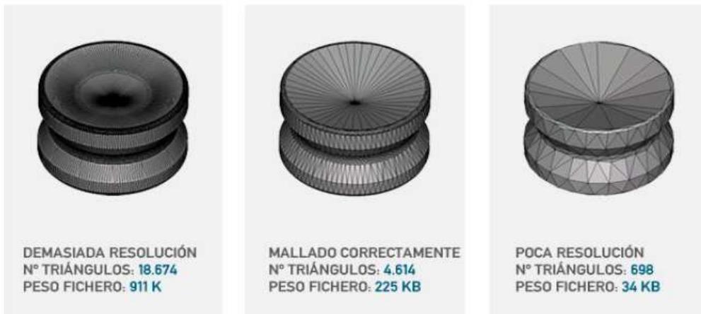
Figura 1-3. Diferentes pesos del archivo STL según la resolución del mallado [4].
