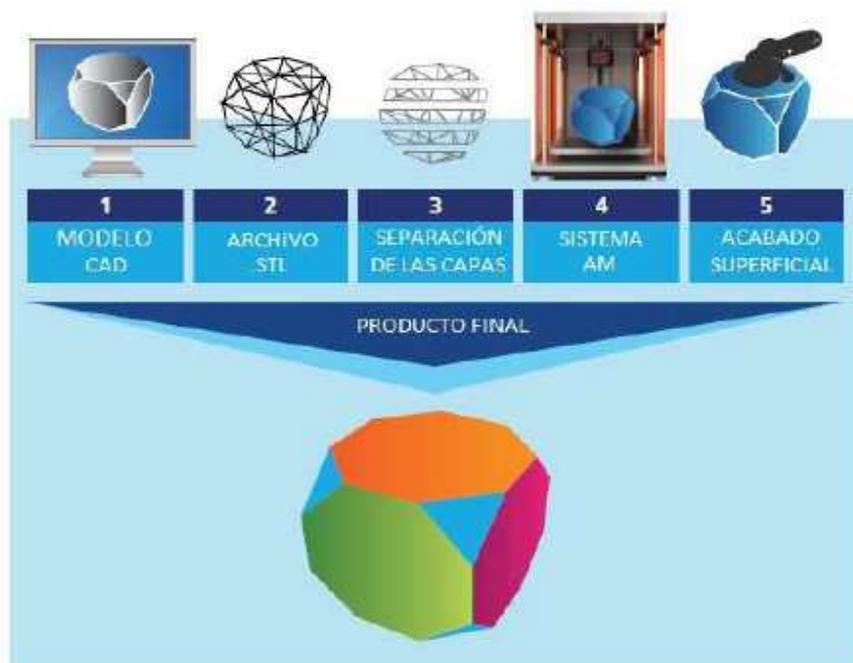
Figura 1-2. Etapas de diseño de un objeto obtenido por fabricación aditiva [3].
