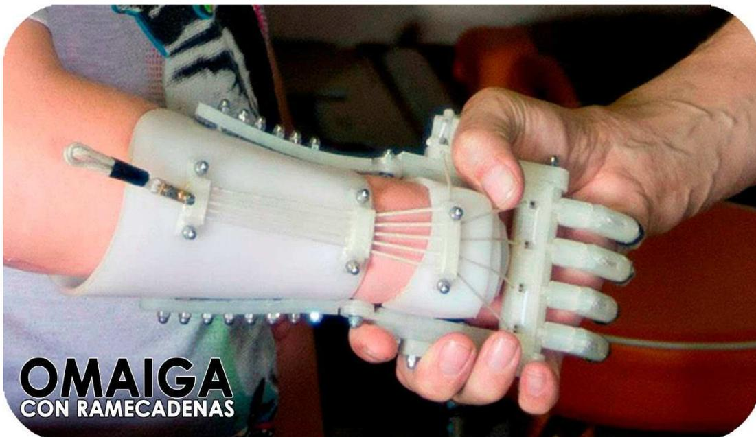
Figura 1-1. Implante realizado mediante fabricación aditiva [20].
